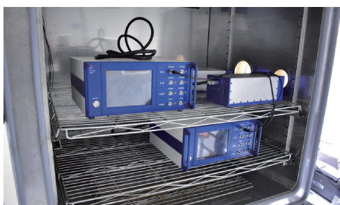
图7 温度试验实物图
