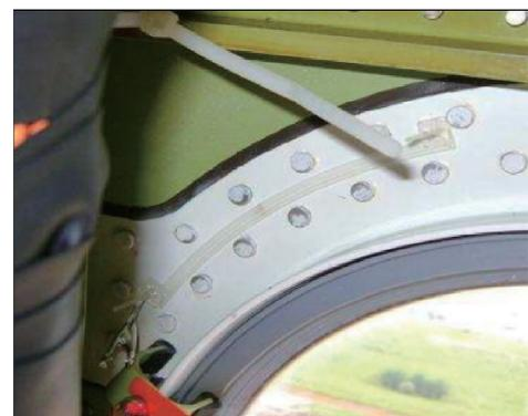
(b) 安装在Embraer-190试验飞机上的CVM传感器
