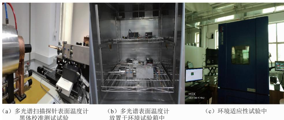
图6 多光谱辐射表面温度计黑体测试和环境试验
