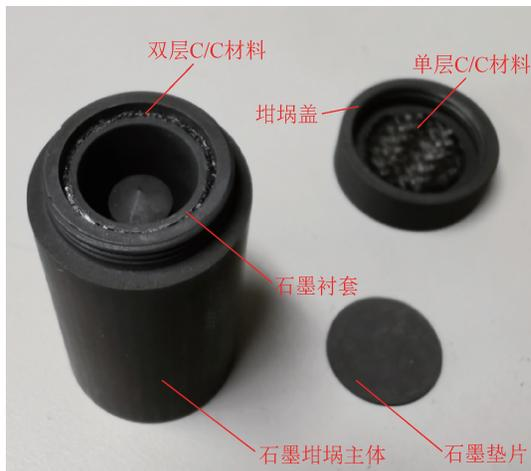
图12 采用外扣式坩埚盖和Hybrid结构的HfC-C包晶点坩埚
