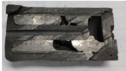
图8 ZrC-C包晶点坩埚侧壁破裂内部情况
