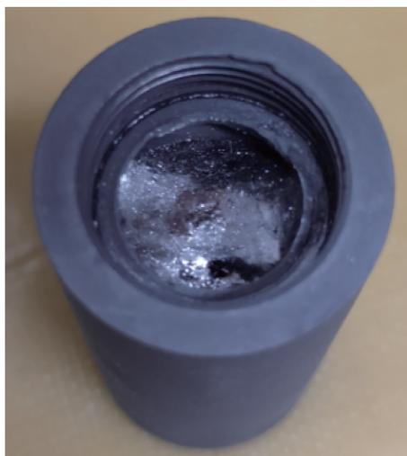
图10 Re-C共晶点复现后金属平面状态
