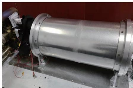
图13 分区式线形阱样机物理系统实物照片
