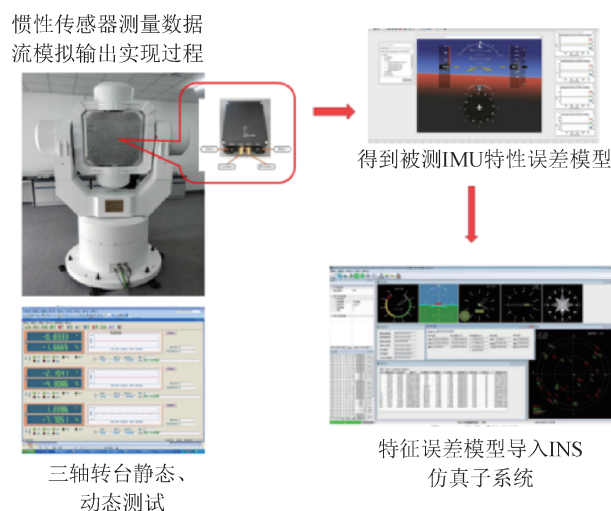
图4 惯性传感器数据流仿真流程
