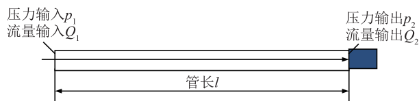
图6 直管引压管腔形式
