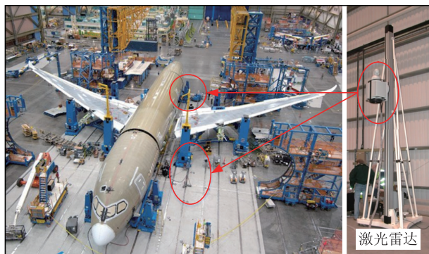
图 2 应用激光雷达进行波音 787 飞机轮廓测量
