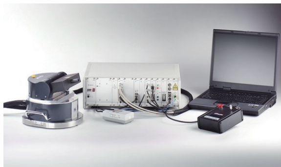
图 3 激光跟踪干涉仪测量系统
