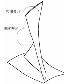
图1 叶型弯扭变形
