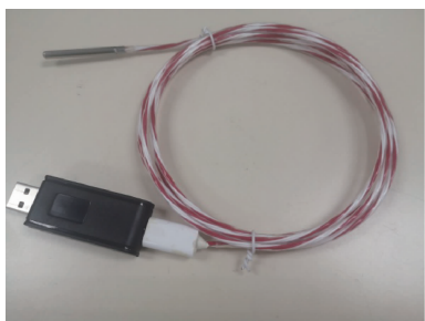
图 2 温度数据采集仪实物图
