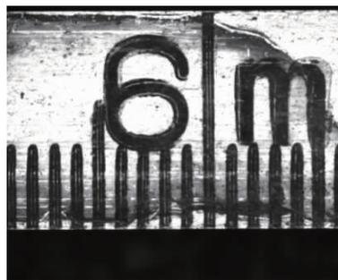
图3 严重磨损的钢卷尺图像
