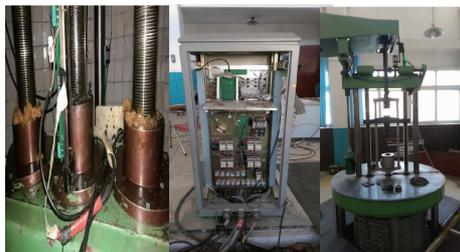
图1 EJI-100型杠杆式力标准机
