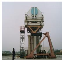
(c) 国内采用模拟发动机代替真实发动机的实物图
