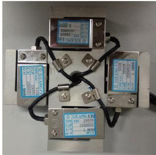
图7 十字形多分量力传感器结构外形
