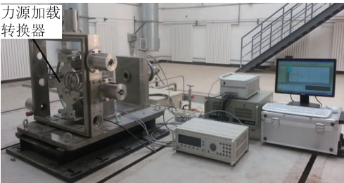
图2 多维力测量与现场原位校准一体化系统
