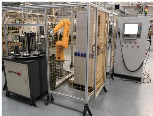
图4 汽车齿轮在线检测系统
