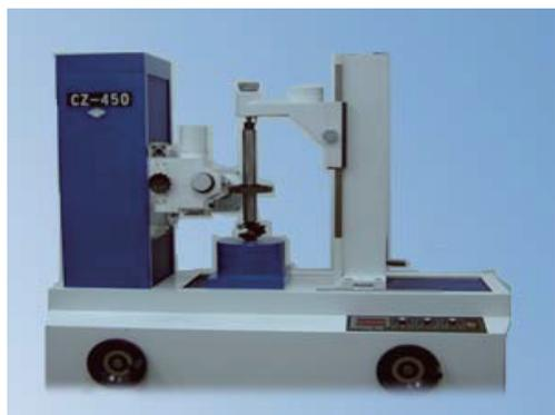
图3 齿轮整体误差测量仪 CZ450
