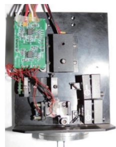
图 53 基于共光路原理探头实物图
