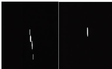
图1 铝箔针孔缺陷图
