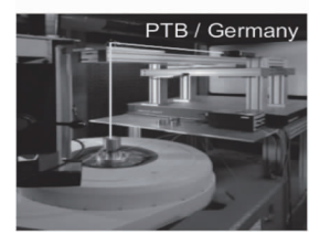
(b) 德国PTB正弦力校准装置 (c) 西班牙CEM和法国LNE正弦力校准装置
