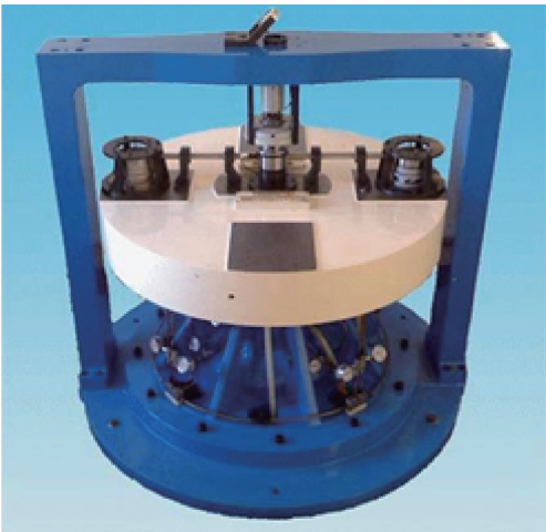
图3 实验用精密离心机 Fig.3 Precision centrifuge for experiment
