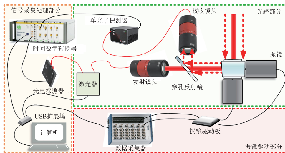
图1 单光子探测系统结构图
