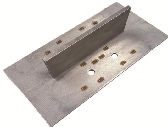
图20 电阻应变传感器布设实物图
