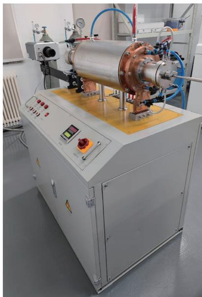
图 3 真空式高温黑体辐射源装置实物图
