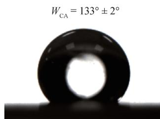
(f) 疏水处理后P-CF3-QCM电极表面静态接触角
