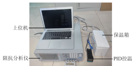
图7 测量系统实物图
