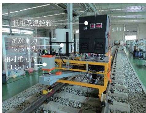
图1 轨道移动绝对重力测量装置
