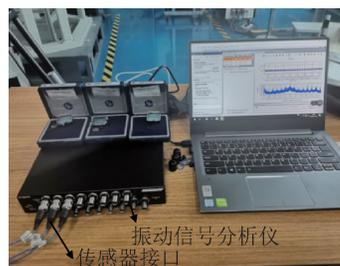
图2 振动信号分析仪
