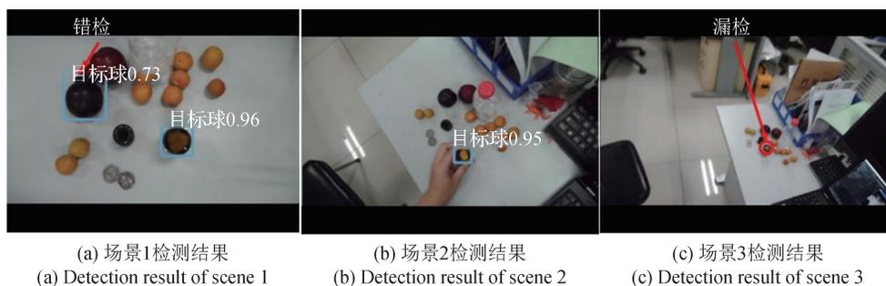
图6 标准YOLOv2模型的不同图像中目标靶球的检测结果
