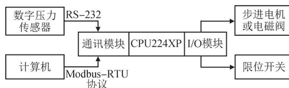
图2 压力控制系统框图
