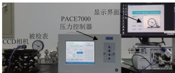
图3 全自动压力校准系统
