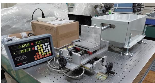
图10 尖轨密贴爬行测量系统实物图
