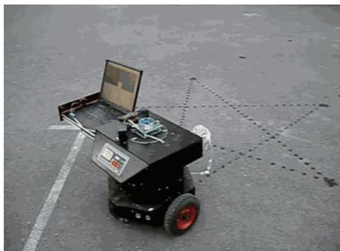
图 18 大连理工大学开发的移动机器人自主导航测试平台
