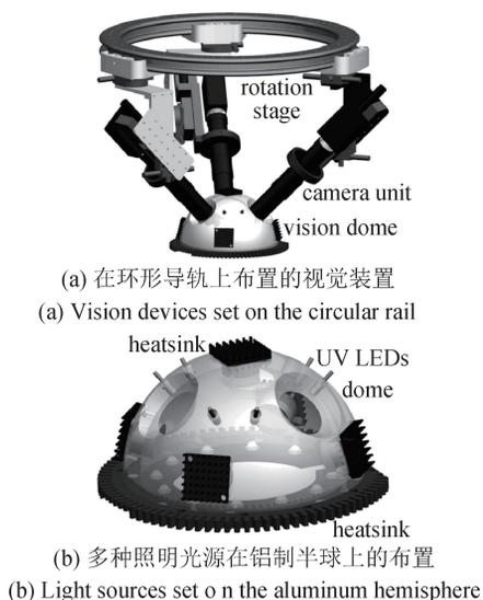
图8 沿半球环形布置的多个相机和光源
