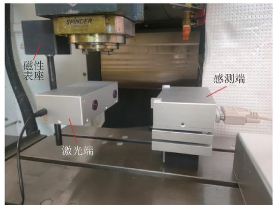
图6 五自由度运动误差测量系统实物图
