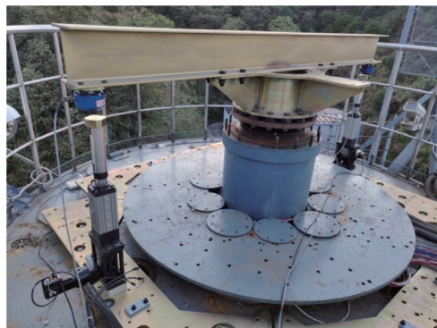
图3 升力加载校准结构
