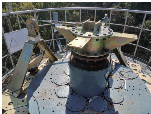
图2 侧向力(阻力)加载校准结构
