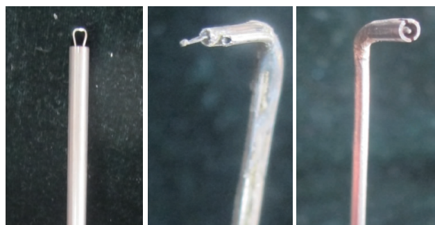
(a) 裸露式对焊 (b) 裸露式两侧带管 (c) 屏蔽式
