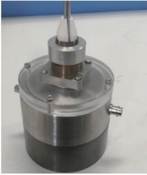
图4 1000 Hz时的高声压发声器和安装的传声器
