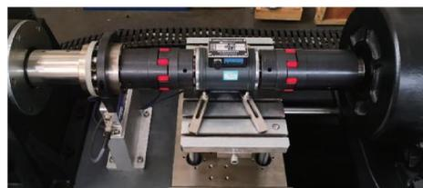
图 12 圆轴结构传感器校准
