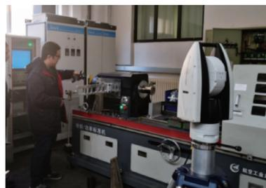
图6 装置杠杆臂长现场校准
