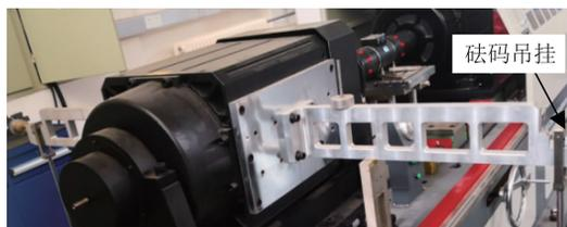
图5 加载电机及力臂杠杆
