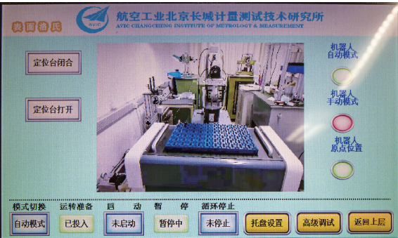
图 4 PLC 总控系统界面
