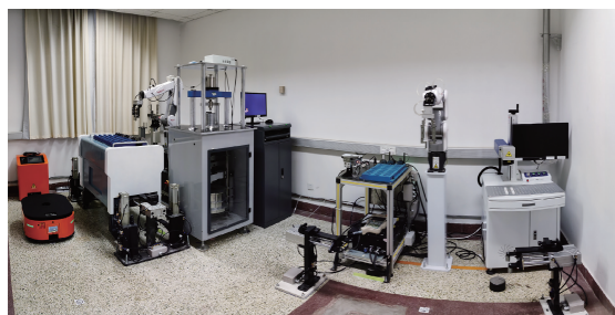
图12 无人值守智能化洛氏硬度测试平台
