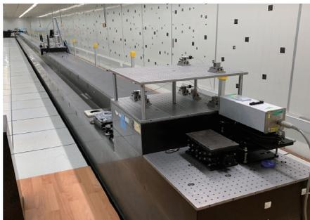
图 8 35 m 激光干涉测长装置
