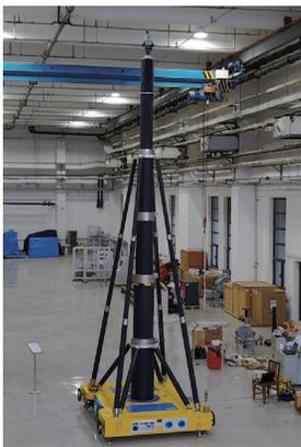
图5 大尺寸测量系统载运支撑装置
