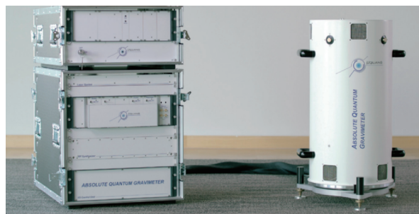
图 18 法国 Muquans 公司研发的原子重力仪
