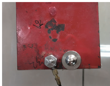
图 5 梁结构上附加不同质量的砝码
