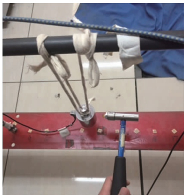
图 4 传感器和测试系统的联合标定
