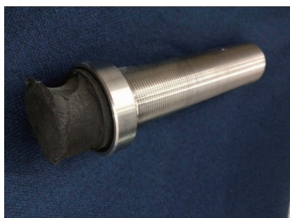
图 12 缓冲装置橡胶块失效形式
