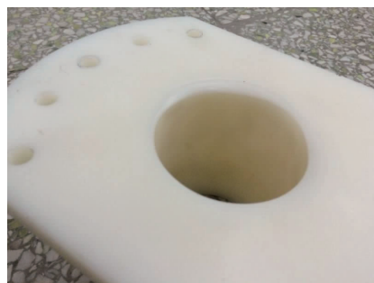
图7 呢绒扶正托架的失效形式
