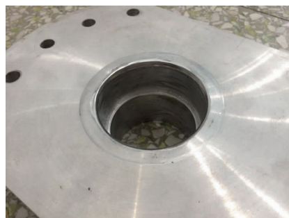
图6 铝合金扶正托架的失效形式
