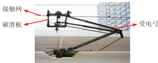
图1 受电弓与接触网接触状态实物图
