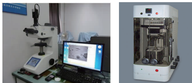
(a) FM-800显微维氏硬度计 (b) UMT-2型多功能材料力学测试系统
