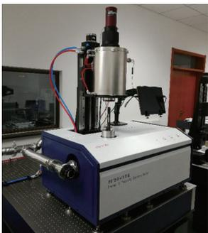
图2 热扩散率测量装置实物图
