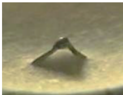
图2 嵌入式“倒 U 型”热电偶
