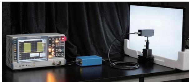
图 4 显示屏闪烁率计量标准装置图
