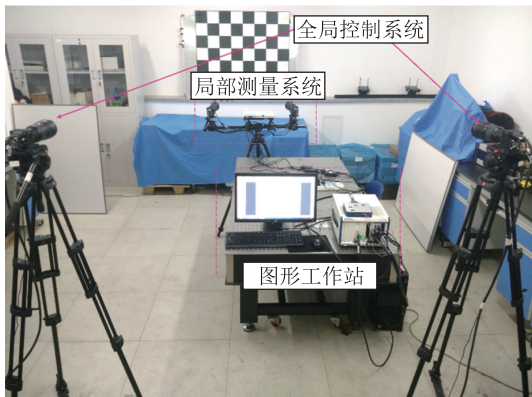
图 4 大型零件三维数据测量系统
