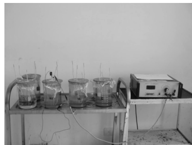
图1 电偶腐蚀计工作现场
