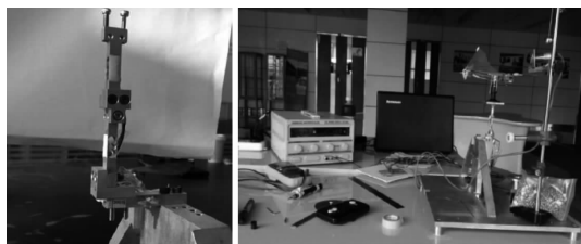
图7 “L”形三维气动力测量装置
